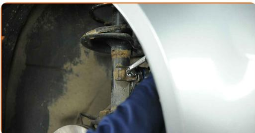
**14** Obdelajte vse spoje opornika stabilizatorja. Uporabite bakreno mast.
