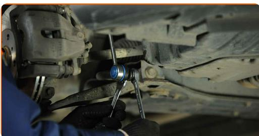
**13** Zategnite pritrdilni element, ki povezuje jarmov drog na blažilnik. Uporabite kombinirani ključ №14. Uporabite imbus št. H6. Uporabite navorni ključ. Zategnite ga do navora 50 Nm.
