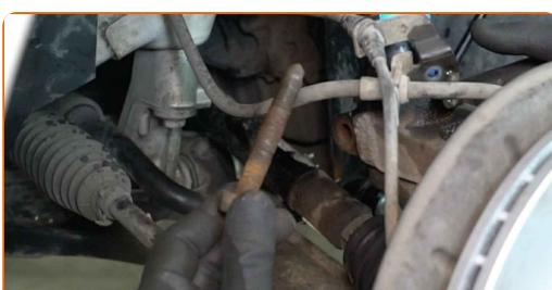
**30** Sprostite spodnji pritrdilni element, ki povezuje blažilnik s premnikom. uporabite poseben nastavek za nasadni ključ za odstranitev blažilnika. Uporabite izvijač z zatikalom.
