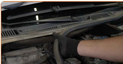
**4** Očistite pritrtilne elemente plastične prevleke brisalca vetrobranskega stekla. Uporabite žično krtačo. Uporabite sprej WD-40.
