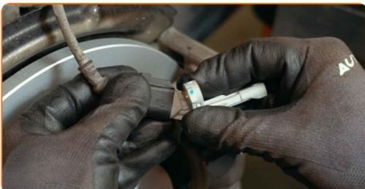
**13** Obdelajte pritrdilni element ABS-senzorja. Uporabite večnamensko mast. Uporabite lomilko.
