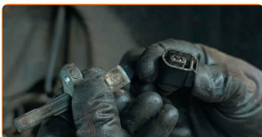
**10** Obdelajte konektor ABS-senzorja. Uporabite dielektrično mast.
