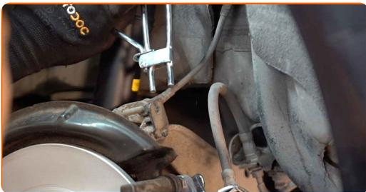
**27** Namestite kabel ročne zavore na nastavek zavorne čeljusti. Uporabite klešče za vodno črpalko.
