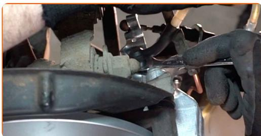
**32** Spustite sistem zavorne čeljusti. Brez zagona motorja pritisnite na zavorni pedal večkrat, dokler ne začutite odpor.
