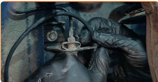
**19** Obdelajte konektor ABS-senzorja. Uporabite dielektrično mast.
