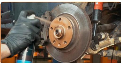
**23** Očistite površino zavornih kolutov. Uporabite čistilo zavor.
