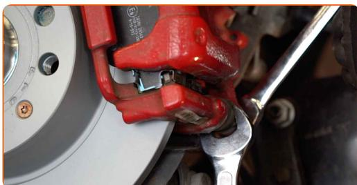
Menjava: zavornih ploščic – SKODA Scala Hatchback. Nasvet AUTODOC strokovnjakov:
