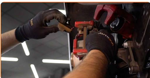
Menjava: zavornih ploščic – SKODA Scala Hatchback. AUTODOC nasvet:
