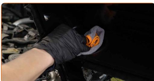
9 Očistite pokrov zračnega filtra in ohišje.
