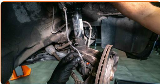
**11** Odvijte pritrdilni element pogonske gredi na pesto kolesa. Uporabite 1-3/16 palčni 12-točkovni nastavek.
