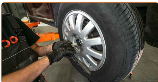
**54** Privijte matico pogonske gredi. Uporabite 1-3/16 palčni 12-točkovni nastavek. Uporabite navorni ključ. Zategnite ga do navora 180 Nm.
