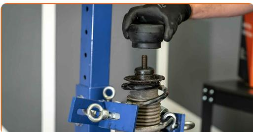
**36** Zategnite matico amortizerja. Uporabite kombinirani ključ №19. Uporabite imbus št. H6. Uporabite navorni ključ. Zategnite ga do navora 60 Nm.
