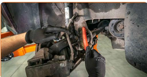
**13** Odvijte pritrdilni element, ki povezuje zglob na kontrolno ročico vzmetenja. Uporabite nasadni ključ №13.
