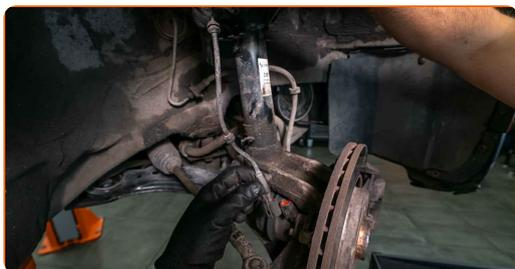
**51** Očistite nosilec platišča kolesa. Uporabite žično krtačo. Obdelajte kontaktno površino. Uporabite bakreno mast.
