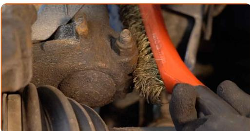
**12** Odvijte spodnji pritrdilni element, ki povezuje blažilnik s premnikom. Uporabite kombinirani ključ №18. Uporabite nasadni ključ №18. Uporabite izvijač z zatikalom.
