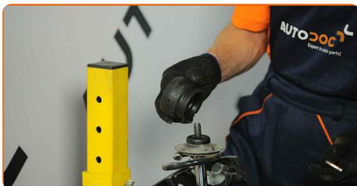
**32** Zategnite matico amortizerja. Uporabite nasadni ključ №20.6. Uporabite imbus št. H6. Uporabite navorni ključ. Zategnite ga do navora 60 Nm.
