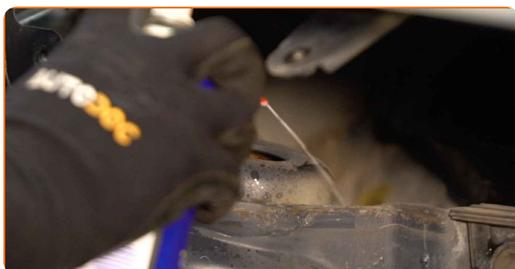
**19** Odvijte zgornje pritrdilne elemente nosilca vzmetne noge. Uporabite nasadni ključ №20.6. Uporabite izvijač z zatikalom.
