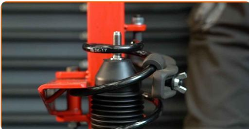
**31** Namestite zgornji nosilec opornika in ležaj nosilca opornika.
