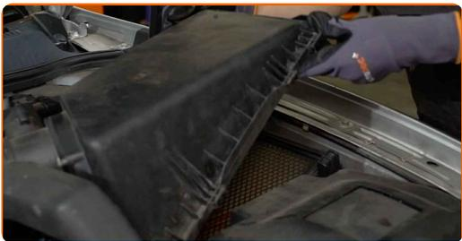
**6** Pokrijte cev za dovod zraka s krpo iz mikrovlaknen, da preprečite vnos prahu in umazanije v sistem.
