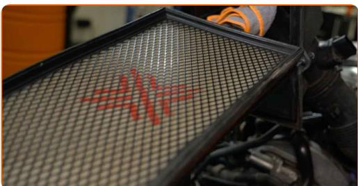
**8** Očistite pokrov zračnega filtra in ohišje.
