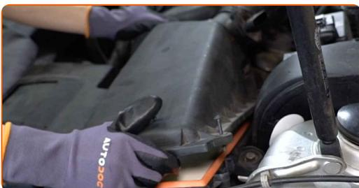
**12** Privijte pritrdilne vijake pokrova zračnega filtra. Uporabite Phillips križni izvijač.
