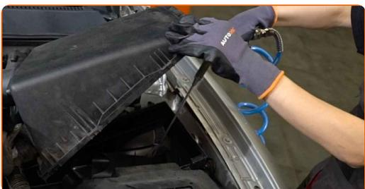
**9** Vstavite nov filtrirni element v ohišje filtra.
