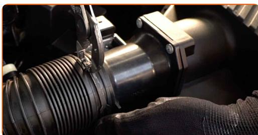
16 Vključite konektor senzorja za masovni pretok zraka.
