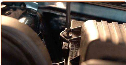
**4** Odstranite vpenjalni kos cevi za dovod zraka. Uporabite klešče za vodno črpalko.
