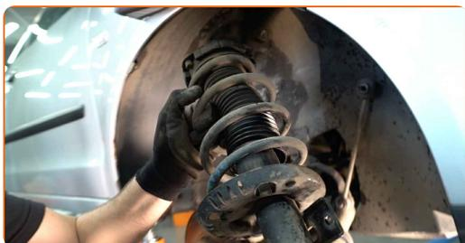
**27** Nastavite opornik amortizerja na orodju kompresorja.
