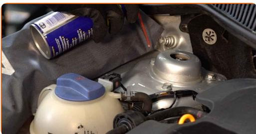
**4** Sprostite zgornji pritrdilni element sedeža za namestitev blažilnika. Uporabite nasadni ključ N°13. Uporabite izvijač z zatikalom.
