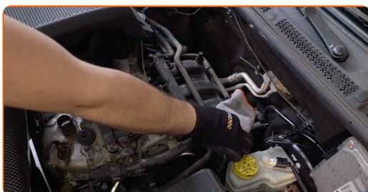
**13** Namestite pokrov motorja in ga pričvrstite. Prepričajte se, da slišite klik, ki kaže na to, da je pravilno nameščena.
