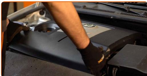
**4** Pokrijte nastavek dušilnih loput s krpo iz mikrovlaknen, da preprečite vdor prahu in umazanije v sistem.
