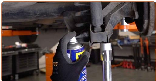
**8** Odvijte spodnjo pritrditev amortizerja. Uporabite nasadni ključ №16. Uporabite kombinirani ključ №16. Uporabite izvijač z zatikalom.
