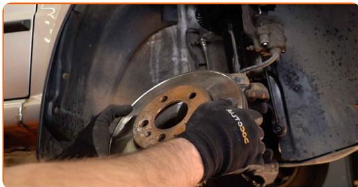
**16** Očistite pesto. Uporabite žično krtačo. Obdelajte kontaktno površino. Uporabite bakreno mast.
