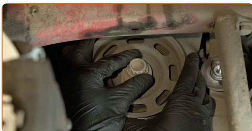
**23** Privijte pritrdilni element jermenice ročične gredi. Uporabite 12-točkovni nastavek Št. 21. Uporabite izvijač z zatikalom.
