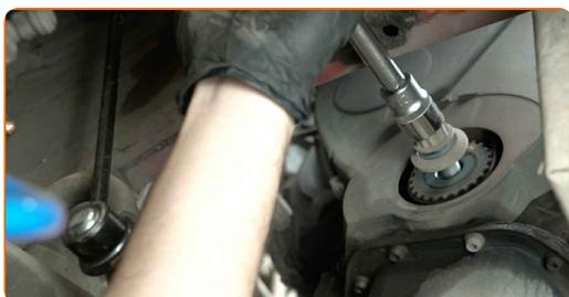
**24** Odvijte pritrditve spodnjega pokrova zobatega jermena. Uporabite nasadni ključ N°10. Uporabite izvijač z zatikalom.
