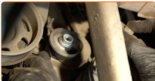
**21** Odvijte pritrditev jermenice ročične gredi. Uporabite 12-točkovni nastavek Št. 21. Uporabite izvijač z zatikalom.
