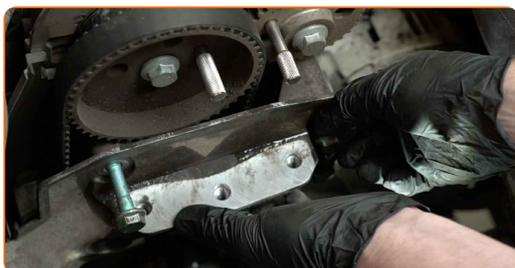
**37** Odstranite vležajenje motorja.
