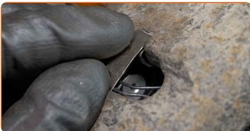
**59** Obdelajte površino, kjer se zavorni kolut stika s platiščem. Uporabite keramično pasto.
