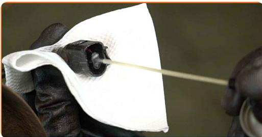
**57** Pritrdite konektor senzorja obrabe zavornih ploščic.
