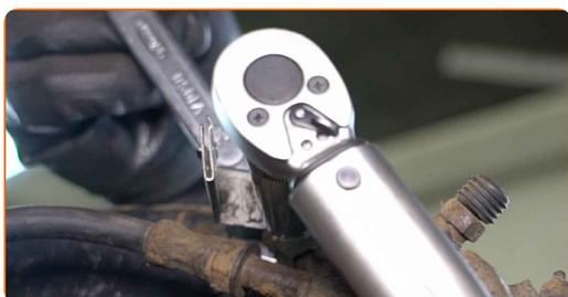
**56** Obdelajte vtič senzorja obrabe zavornih ploščic. Uporabite dielektrično mast.
