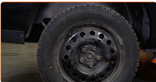
**64** Zategnite pritrdilni element pesta. Uporabite kombinirani ključ №24. Uporabite nasadni ključ №24. Uporabite navorni ključ. Zategnite ga do navora 200 Nm.
