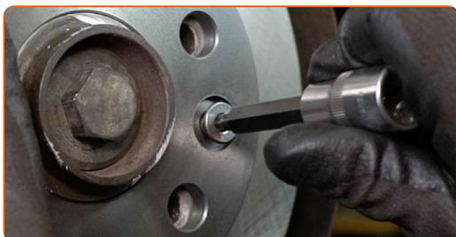
**46** Zategnite pritrditve zavornega diska. Uporabite imbus št. H6. Uporabite navorni ključ. Zategnite ga do navora 10 Nm.
