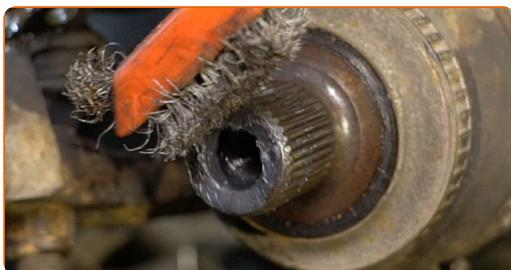
**61** Obdelajte ozobje pogonske gredi homokinetičnega zgloba. Uporabite bakreno mast.
