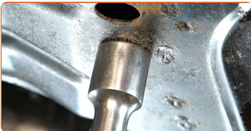
**11** Odvijte zadnji pritrdilni vijak prečnega vodila. Uporabite nasadni ključ №21. Uporabite izvijač z zatikalom.
