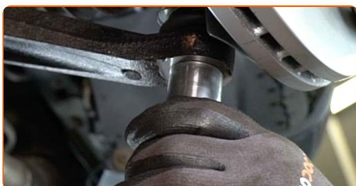
**28** Obdelajte vse dele prečnega vodila. Uporabite bakreno mast.
