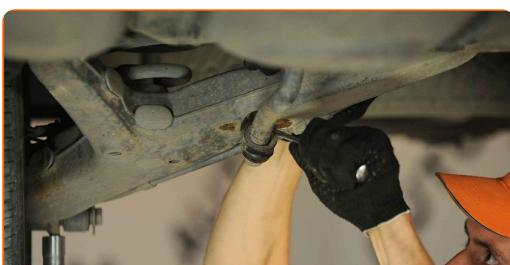
**7** Očistite sedeže za namestitev puš stabilizatorja. Uporabite žično krtačo. Uporabite sprej WD-40.
