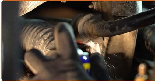
**3** Odvijte pritrdilne elemente nosilcev puš stabilizatorja. Uporabite nasadni ključ №13. Uporabite izvijač z zatikalom.
