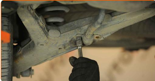
**4** Odstranite nosilce puš stabilizatorja. Uporabite ploščat izvijač.
