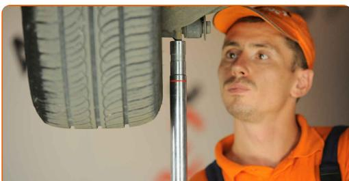
**6** Odstranite puše stabilizatorja. Uporabite ploščat izvijač. Uporabite klešče za vodno črpalko.
