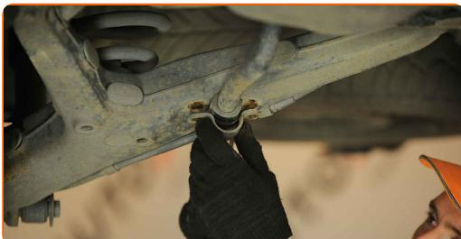
**5** Pričvrstite tram zadnje osi. Uporabite dvigalko s hidravličnim prenosom.
