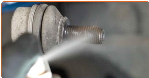
**58** Namestite prečno povezavo stabilizatorja.
