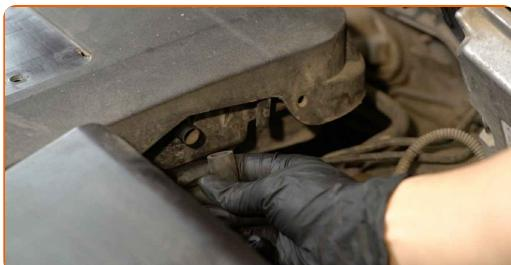
4 Odstranite pokrov motorja v sestavi z ohišjem zračnega filtra.
