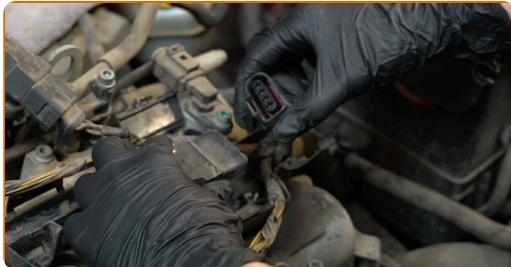
**8** Obdelajte konektor vžigalne tuljave s sprejem za elektroniko. Sprej bo zaščitil električne kontakte pred korozijo, oksidacijo in bo zmanjšal upor kontaktov.
