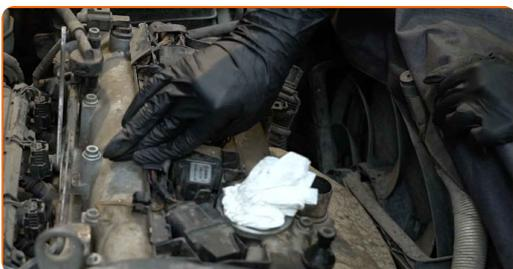
**23** Privijte priključek za ozemljitev vžigalne tuljave. Uporabite nasadni ključ №10. Uporabite izvijač z zatikalom.
