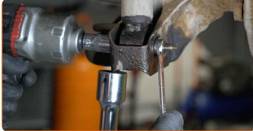
9 Odvijte zgodnjo pritrditev amortizerja. Uporabite nasadni ključ №16. Uporabite izvijač z zatikalom.
