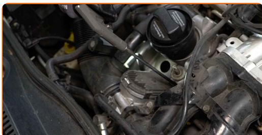
**5** Odvijte vžigalne svečke. Uporabite nastavek ključa za vžigalne svečke št. 16. Uporabite izvijač z zatikalom.
