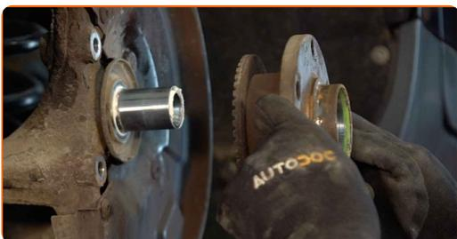
**20** Očistite nosilec ležaja pesta. Uporabite večnamenski čistilni sprej.
