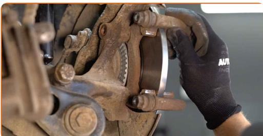
**30** Zategnite nosilec zavorne čeljusti. Uporabite imbus št. H8. Uporabite navorni ključ. Zategnite ga do navora 75 Nm.
