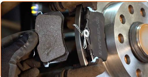
**34** Namestite zavorno čeljust in jo privijte. Uporabite nasadni ključ №13. Uporabite kombinirani ključ №15. Uporabite navorni ključ. Zategnite ga do navora 35 Nm.
