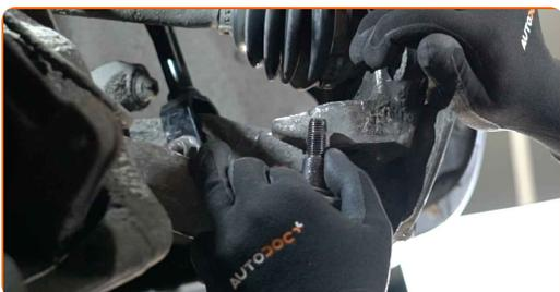
**20** Odklopite zglob od volanskega členek. Uporabite snemalec nosilnega zgiba.
