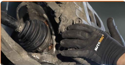
**78** Zategnite nosilec zavorne čeljusti. Uporabite nasadni ključ №21. Uporabite navorni ključ. Zategnite ga do navora 190 Nm.
