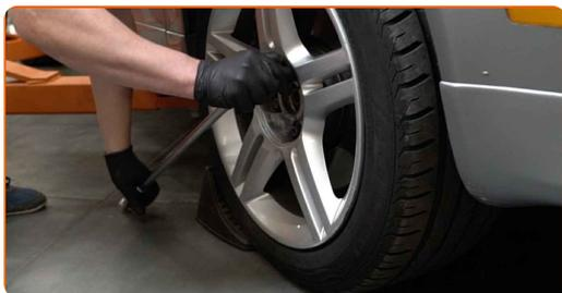
**3** Sprostite pritrdilni element pogonske gredi. Uporabite imbus št. H17. Uporabite udarni nasadni ključ.
