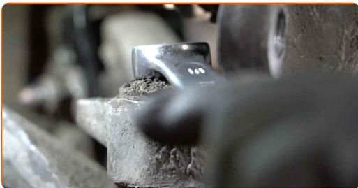
**18** Odklopite zglob od volanskega členek. Uporabite snemalec nosilnega zgiba.
