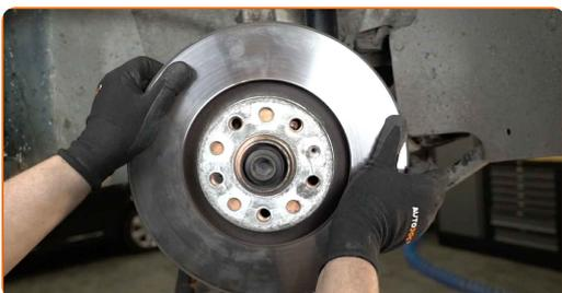
**76** Zategnite pritrditve zavornega diska. Uporabite vijačni nastavek T30. Uporabite navorni ključ. Zategnite ga do navora 5 Nm.
