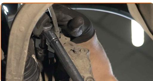
**79** Zategnite pritrditev krogličnega zgloba. Uporabite nasadni ključ №18. Uporabite navorni ključ. Zategnite ga do navora 110 Nm.
