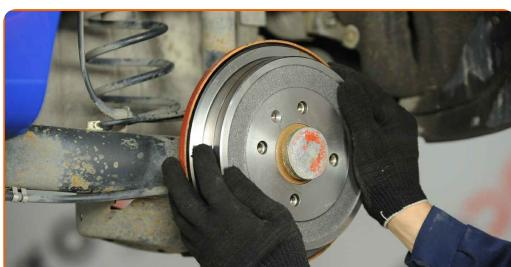
**11** Zategnite pritrdilne elemente zavornega bobna. Uporabite Phillips križni izvijač. Uporabite navorni ključ. Zategnite ga do navora 4 Nm.
