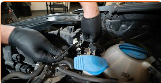
3 Odstranite nosilec žarnice tako, da ga obrnete za približno 30°. Odstranite nosilec iz nosilca žaromet.
