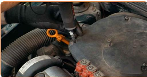
**4** Odstranite ohišje zračnega filtra.
