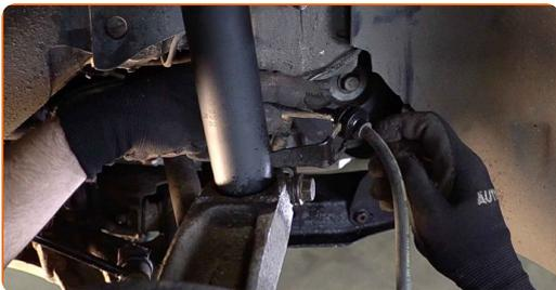
**61** Namestite prečno povezavo stabilizatorja.
