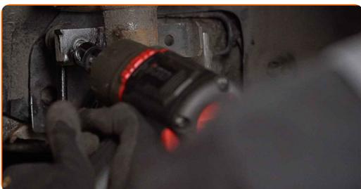
**17** Odklopite kable in zavorno cev iz nosilca za amortizer. Uporabite lomilko.
