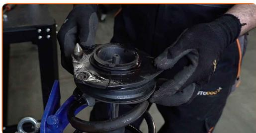
**43** Zategnite matico amortizerja. Uporabite kombinirani ključ №19. Uporabite imbus št. H6. Uporabite navorni ključ. Zategnite ga do navora 60 Nm.
