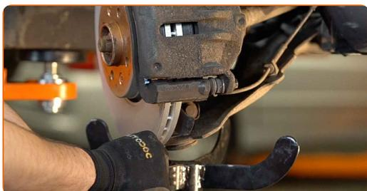
**25** Sprostite spodnji pritrdilni element, ki povezuje blažilnik s premnikom. uporabite poseben nastavek za nasadni ključ za odstranitev blažilnika. Uporabite izvijač z zatikalom.
