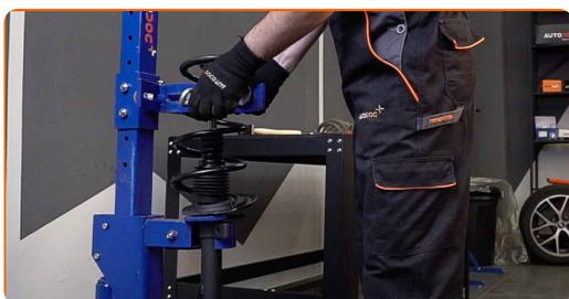
**42** Namestite zgornji nosilec opornika in ležaj nosilca opornika.
