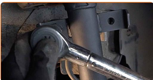
**63** Obdelajte pritrdilne elemente blažilnika. Uporabite bakreno mast.
