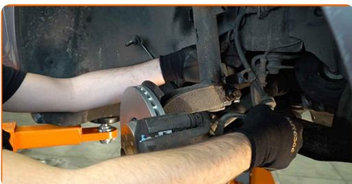
**18** Odvijte spodnji pritrdilni element, ki povezuje blažilnik s premnikom. Uporabite nasadni ključ №18. Uporabite udarni nasadni ključ.
