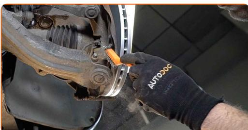
**21** Odvijte žogo skupno pritrditev na volanskem členek. Uporabite nasadni ključ №17. Uporabite izvijač z zatikalom.
