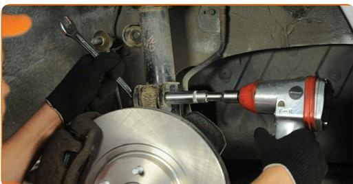
**10.2** Uporabite kombinirani ključ №19. Uporabite nasadni ključ №17. Uporabite izvijač z zatikalom.
