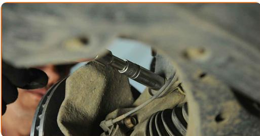
**11** Odklopite napeljavo ABS senzorja.
