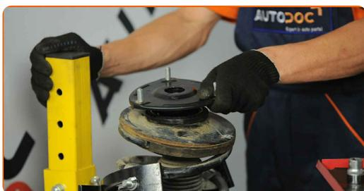
**34** Zategnite matico amortizerja. Uporabite nasadni ključ №19. Uporabite navorni ključ. Zategnite ga do navora 64 Nm.
