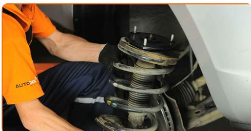
**20** Nastavite opornik amortizerja na orodju kompresorja.
