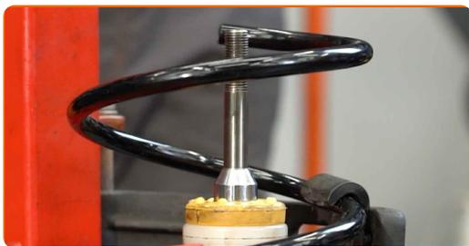
**33** Namestite zgornji nosilec opornika in ležaj nosilca opornika.
