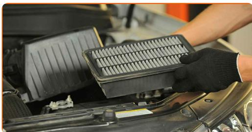
**6** Očistite pokrov zračnega filtra in ohišje.
