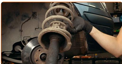
25 Nastavite opornik amortizerja na orodju kompresorja.
