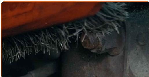
**19** Odvijte pritrdilne elemente, ki povezujejo vzmetno nogo s premnikom. Uporabite kombinirani ključ №21. Uporabite nasadni ključ №21. Uporabite izvijač z zatikalom.
