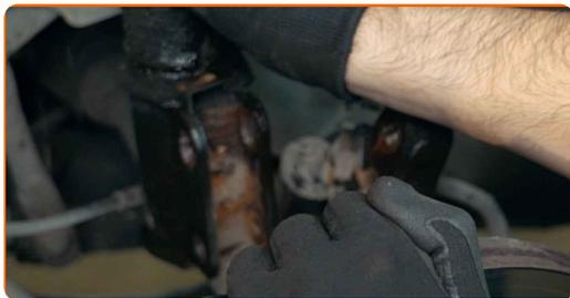
23 Odvijte pritrdilne elemente na vrhu nosilca amortizerja.
