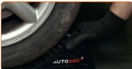
60 Zategnite zgornje pritrdilne elemente nosilca vzmetne noge. Uporabite nasadni ključ N°13. Uporabite navorni ključ. Zategnite ga do navora 30 Nm.
