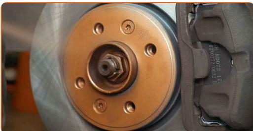
**55** Očistite površino zavornih kolutov. Uporabite čistilo zavor.
