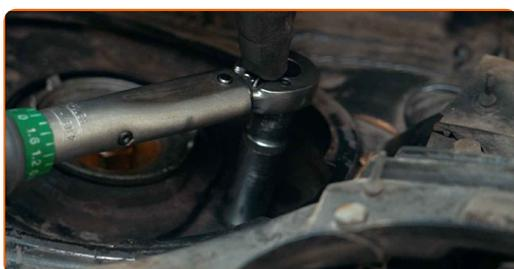
61 Obdelajte pritrdilne elemente sedeža za namestitev blažilnika. Uporabite bakreno mast.
