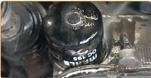
**11** Odvijte oljni filter. Uporabite natični ključ 65-14F. Uporabite izvijač z zatikalom.
