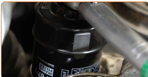
**17** Očistite oljni filter. Uporabite večnamenski čistilni sprej.
