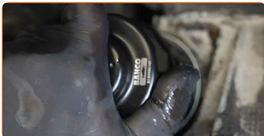
**16** Privijte oljni filter. Ne pozabite upoštevati priporočenega navornega ključa. Uporabite natični ključ 65-14F. Uporabite navorni ključ. Zategnite ga do navora 24 Nm.
