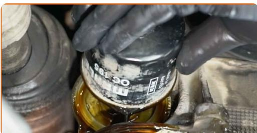
**13** Očistite nosilec oljnega filtra. Uporabite večnamenski čistilni sprej.
