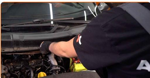
**19** Privijte pritrdilni element zaščitne maske vetrobranskega stekla nameščene na levi strani. Uporabite nasadni ključ №10. Uporabite izvijač z zatikalom.
