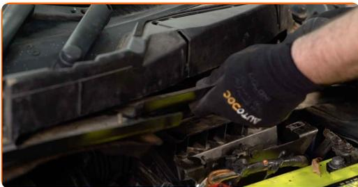
**17** Privijte pritrdilne vijake zaščitnega pokrova. Uporabite nasadni ključ №10. Uporabite izvijač z zatikalom.
