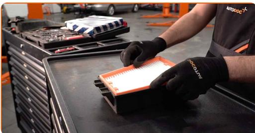
Menjava: zračni filter – RENAULT Megane III Hatchback (BZ0/1\_). AUTODOC nasvet:
