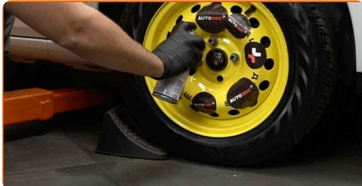
4 Odvijte pritrdilni element pogonske gredi na pesto kolesa. Uporabite nasadni ključ №30. Uporabite udarni nasadni ključ.
