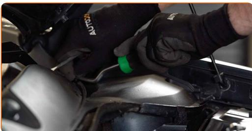
**4** Nekoliko dvignite pokrov za namestitev blažilnika. Obdelajte pritrdilne elemente sedeža za namestitev blažilnika. Uporabite sprej WD-40.
