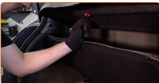
**3** Odvijte zgodnjo pritrditev amortizerja. Uporabite nasadni ključ №16. Uporabite izvijač z zatikalom.
