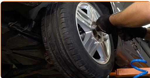
**27** Spustite avto in z delanjem v navzkrižnem vrstnem redu, zategnite kolesne vijake. Uporabite navorni ključ. Zategnite ga do navora 110 Nm.
