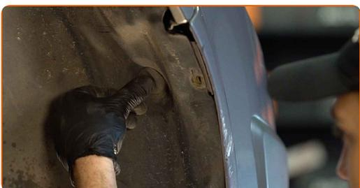
**21** Očistite nosilec platišča kolesa. Uporabite žično krtačo. Obdelajte kontaktno površino. Uporabite bakreno mast.
