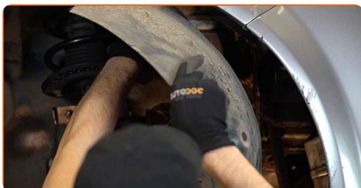
**10** Odvijte pritrdilne elemente, ki povezujejo prednji nosilec odbijača na pomožni okvir. Uporabite nasadni ključ №13.
