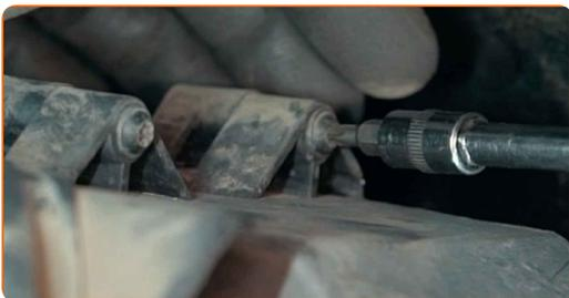
**9** Odstranite ohišje zračnega filtra.
