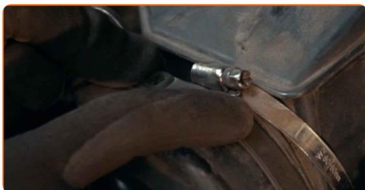
**19** Privijte pritrdilno objemko, ki povezuje zračni kanal z ohišjem zračnega filtra. Uporabite nasadni ključ №7. Uporabite udarni nasadni ključ.
