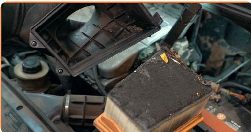
**11** Očistite ohišje zračnega filtra.
