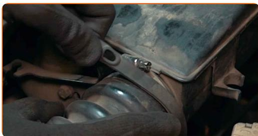
**5** Odstranite ohišje zračnega kanala iz ohišja zračnega filtra.
