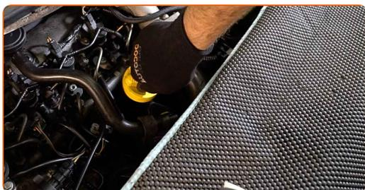
**23** Pustite da motor nekaj minut deluje. Ko ugasne opozorilna lučka za pritisk olja, ugasnite motor.
