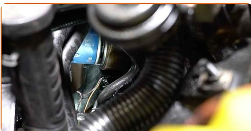
**10** Pripravite posodo za stari oljni filter. Odložite stari oljni filter v posodo.
