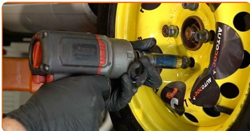
**108** Spustite avto in z delanjem v navzkrižnem vrstnem redu, zategnite kolesne vijake. Uporabite kolesni nasadni nastavek št. 17 Uporabite navorni ključ. Zategnite ga do navora 105 Nm.
