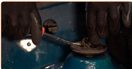
**4** Sprostite zgornji pritrdilni element sedeža za namestitev blažilnika. Uporabite kombinirani ključ №21. Uporabite imbus št. H6. Uporabite izvijač z zatikalom.
