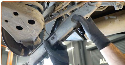
**15** Očistite nosilce in ležaje prečnega vodila. Uporabite žično krtačo. Uporabite sprej WD-40.
