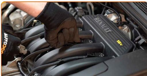
4 Odvijte nosilec vžigalne tuljave. Uporabite nasadni ključ №10. Uporabite izvijač z zatikalom.
