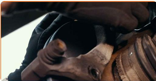
**23** Zategnite nosilec zavorne čeljusti. Uporabite nasadni ključ №18. Uporabite navorni ključ. Zategnite ga do navora 100 Nm.
