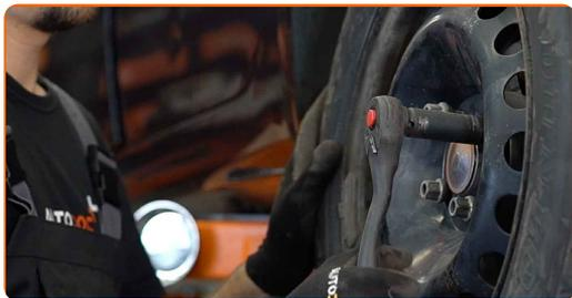
**21** Spustite avto in z delanjem v navzkrižnem vrstnem redu, zategnite kolesne vijake. Uporabite navorni ključ. Zategnite ga do navora 110 Nm.
