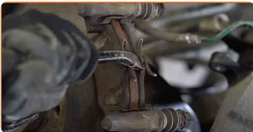
**12** Očistite umazanijo in prah iz nosilca zavorne čeljusti. Uporabite žično krtačo. Uporabite čistilo zavor.
