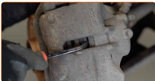
**8** Očistite umazanijo in prah iz nosilca zavorne čeljusti. Uporabite žično krtačo. Uporabite sprej WD-40.
