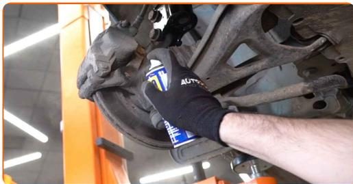
**9** Odvijte pritrditve nosilec čeljusti. Uporabite nasadni ključ №18. Uporabite izvijač z zatikalom. Uporabite udarni nasadni ključ.
