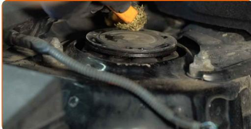
**4** Sprostite zgornji pritrdilni element sedeža za namestitev blažilnika. Uporabite nasadni ključ №14. Uporabite izvijač z zatikalom.
